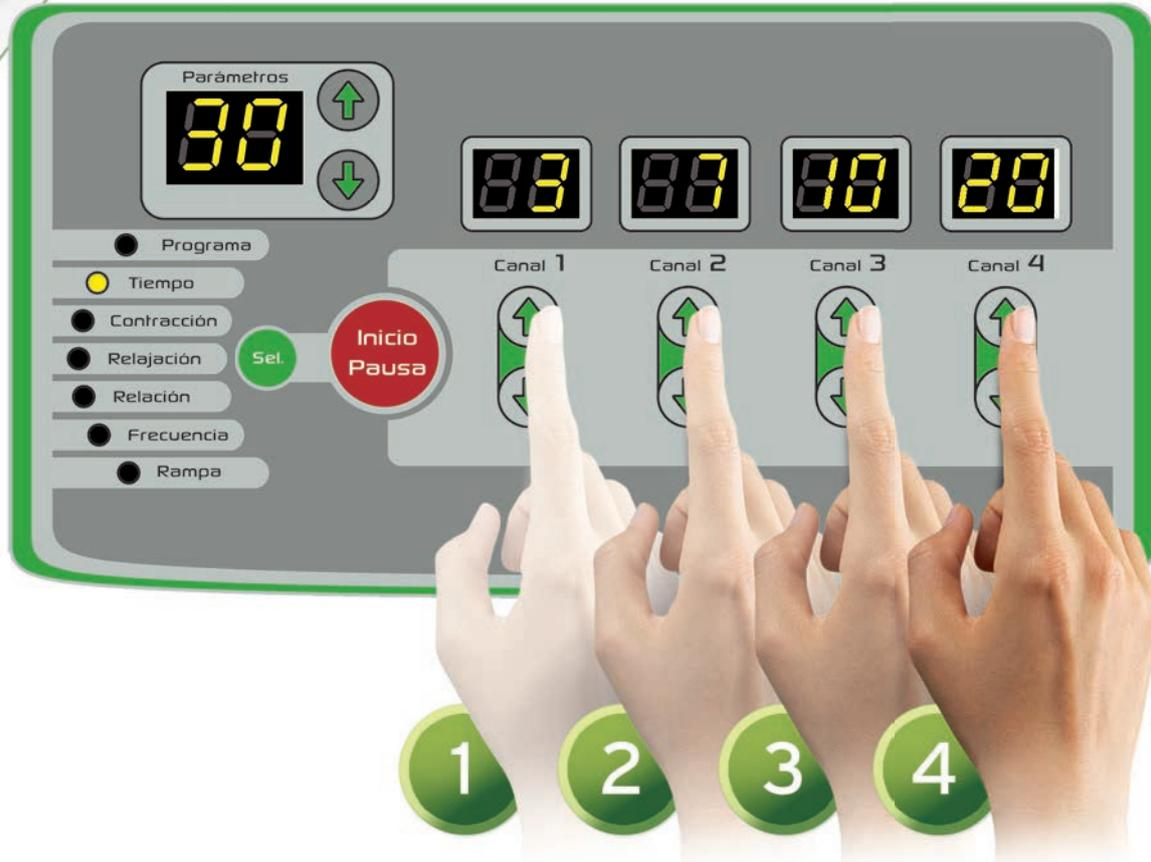
Cuando el equipo detecta señal de salida por sus canales, independientemente del valor de amplitud de la onda, los displays de visualización se encienden de manera constante y con alta luminosidad.
