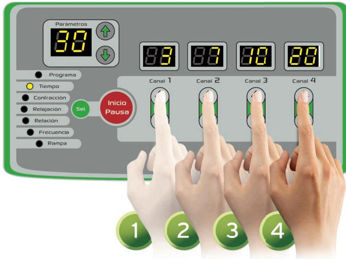
Siguiendo esta lógica, cuando se trabaja con ondas cuadradas o TENS, los displays se encuentran encendidos permanentemente, indicando señal activa en todo momento (salvo que el programa interrumpa en algún punto la salida de manera predeterminada).
